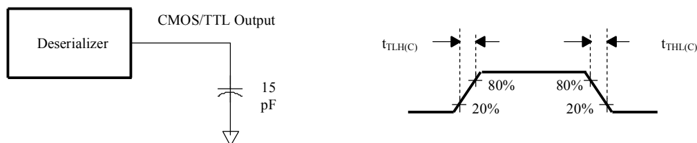
图 7.解串器 CMOS/TTL Output Load and Transition Times
